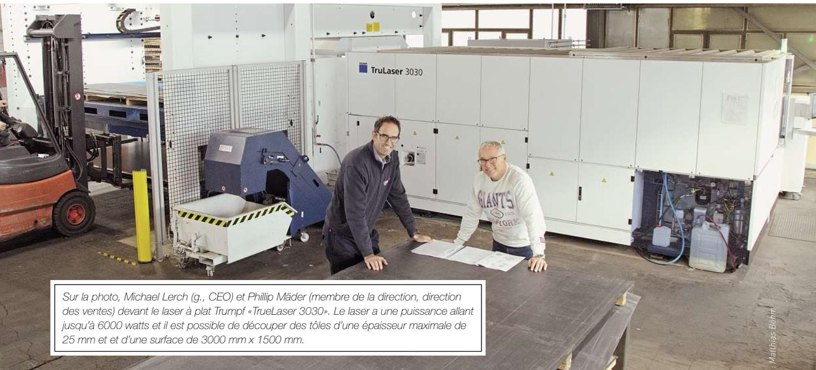
Sur la photo, Michael Lerch (g., CEO) et Phillip Mäder (membre de la direction, direction des ventes) devant le laser à plat Trumpf «TruLaser 3030». Le laser a une puissance allant jusqu'à 6000 watts et il est possible de découper des tôles d'une épaisseur maximale de 25 mm et et d'une surface de 3000 mm x 1500 mm.
