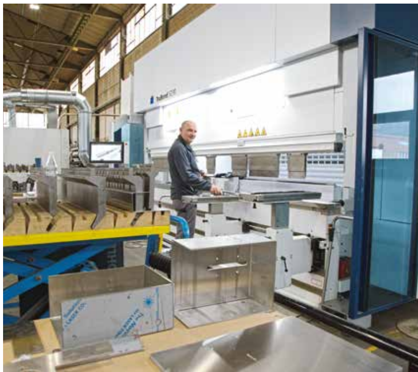
Auf der Trumpf-Abkantpresse «TruBend 5230 S» werden Bleche bis zu 4000 mm Länge verarbeitet.
