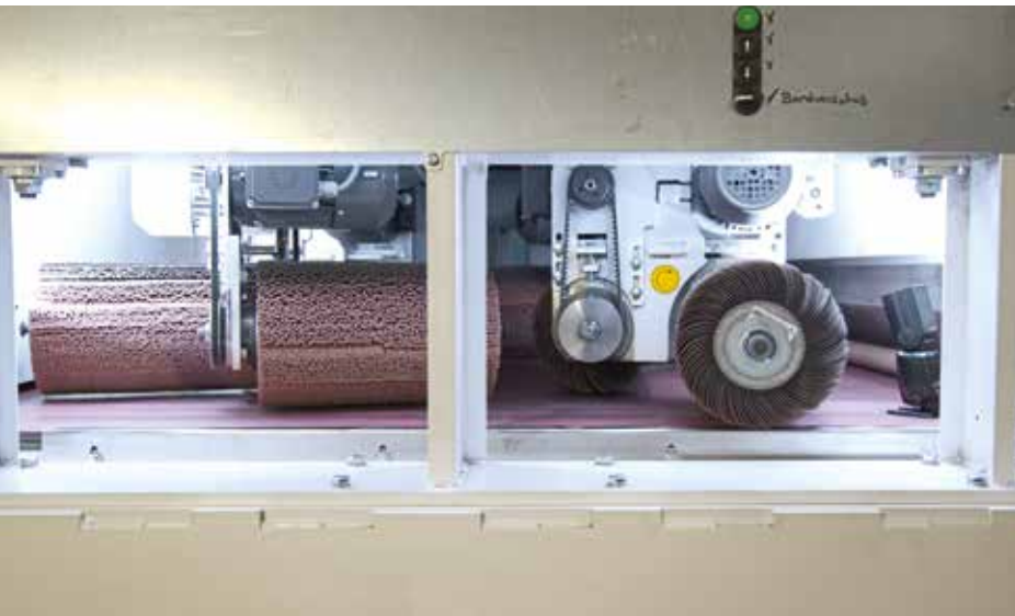
Die jüngste Investition ist eine Schleif- und Entgratmaschine von Lissmac «SMD 345», auf der Bleche ein perfektes Finishing erhalten.
