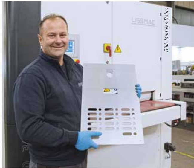
Die jüngste Investition ist eine Schleif- und Entgratmaschine von Lissmac «SMD 345», auf der Bleche ein perfektes Finishing erhalten.
